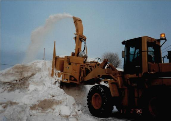
Equipo Barrenieve tipo "quita y pon" acoplado a una cargadora frontal
