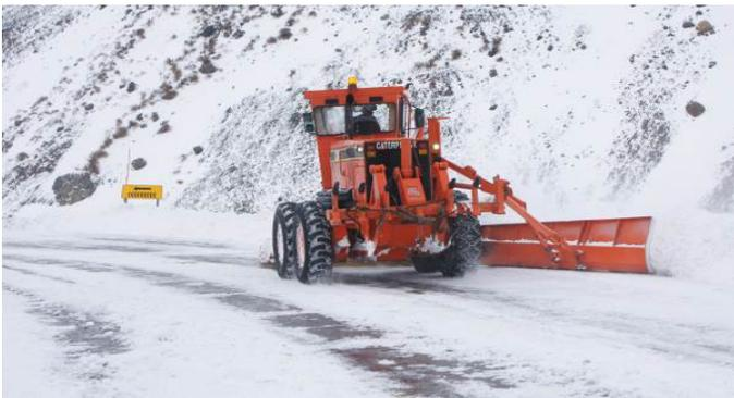
Motoniveladora equipada para despejar nieve en calzada
