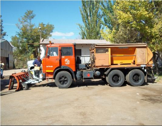
Camión distribuidor de sal sobre la calzada con pala frontal para limpieza
